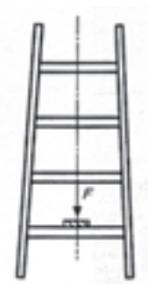
Fig. 4/5 Par. 4.6 PROVA DI FLESSIONE DI PIOLI O GRADINI O PIATTAFORMA
